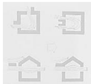
Gambar 7. Ventilasi silang (Sumber: Karyono, 2016)
