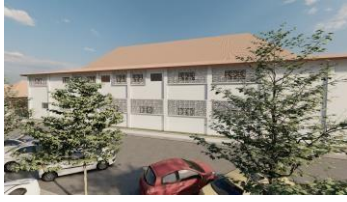
Gambar 8. Double Skin pada bangunan kantor Sumber: Olah Data, 2021
